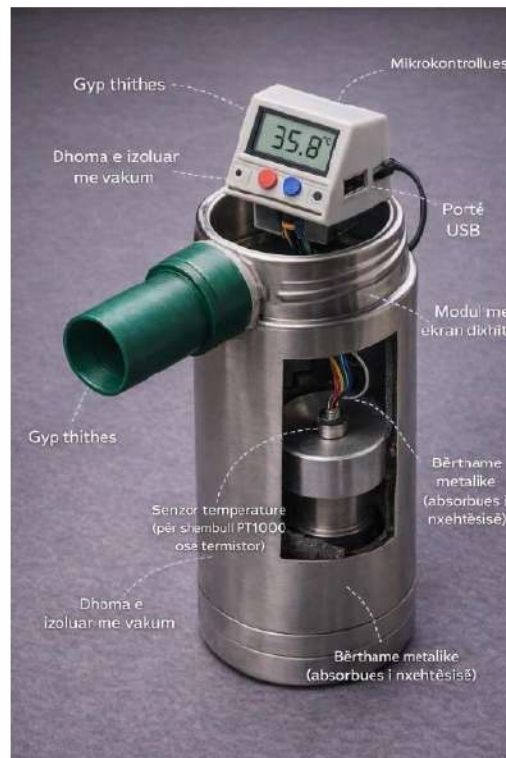
Figurë 7. Modeli i pajisjes së matjes së temperaturës së ajrit të ekspiruar
